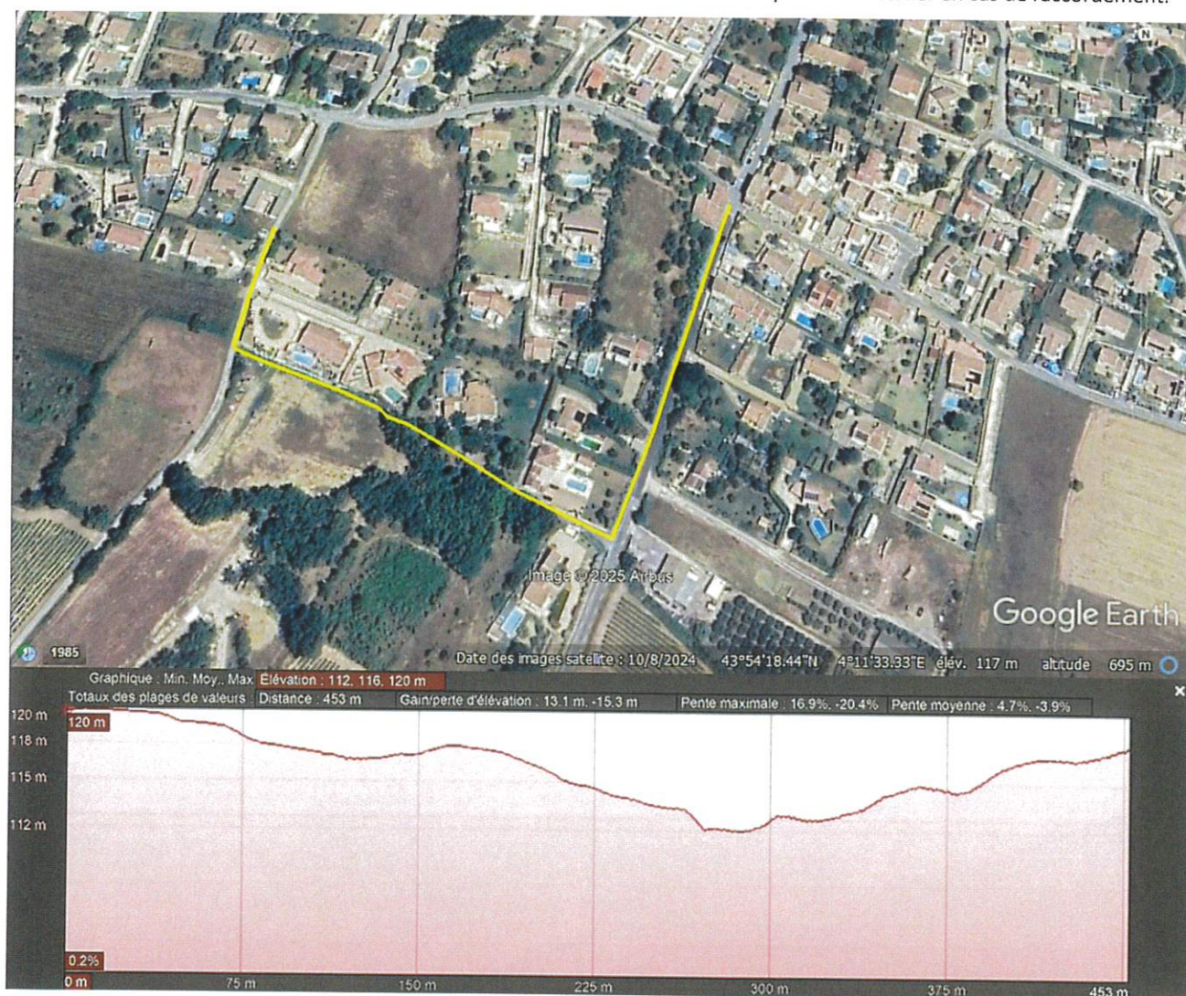
Figure 14 : Profil altimétrique du potentiel futur réseau d'assainissement
